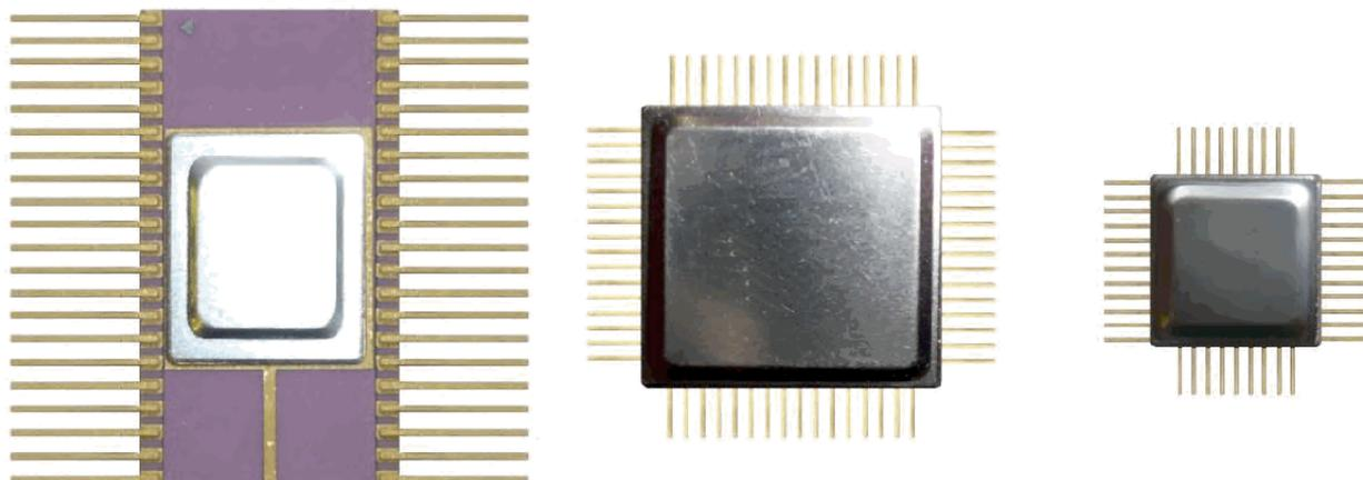
**1537XM1T, H1537XM1 и 1537XM1Y** - базовые матричные кристаллы (БМК) ёмкостью до 3,2 тыс. вентиляей на КМОП структурах, предназначенные для использования в вычислительных системах специального назначения.
