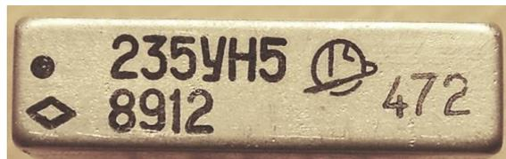
**Назначение:** усилитель сигналов низкой частоты с парафазным выходом.
