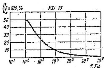
Зависимость допустимой амплитуды напряжения переменного тока или переменной составляющей пульсирующего тока от частоты
