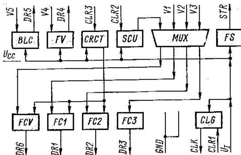
В состав БИС входят: схема контроля питания SCU; схема блокировки питания BLC; схема выработки сигнала начала отработки выдержки FV; схема корректировки тока нагрузки CRCT; коммутатор MUX; схема формирования сигнала начала работы фотокамеры FS; схема формирования сигнала управления светодиодом FCV; схемы формирования сигналов управления первым - третьим электромагнитами FCA — FC3; генератор тактовой частоты CLG.
