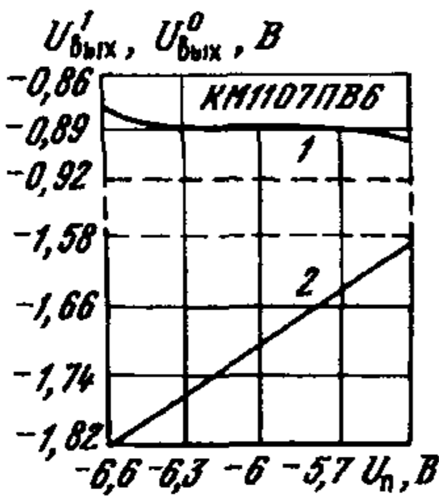
Типовые зависимости выходного напряжения высокого ( U^1_{вых} ) и низкого ( U^0_{вых} ) уровней КМ1107ПВ6 от напряжения питания при T = +25^\circ\text{C}
