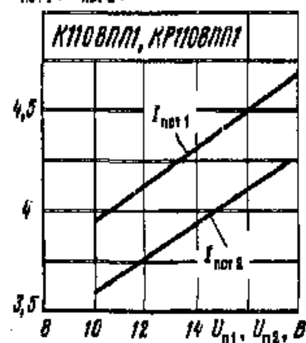
Зависимости токов потребления от напряжений источников питания
