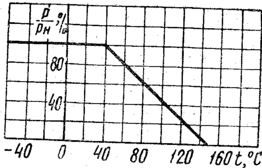
$P$  — допускаемая мощность электрической нагрузки, Вт;
